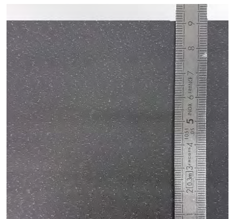
Figure 2 - Coupe d'un laminé de 150 plies Épaisseur de 92 mm Niveau de porosité inférieur à 1%
